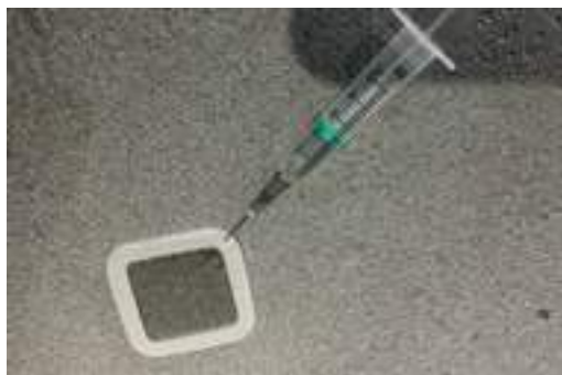
Test de Bresle (test de contamination saline)
