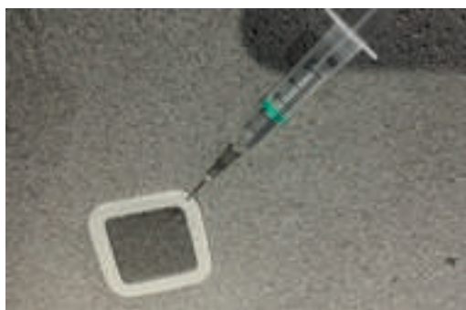
Test de Bresle (test de contamination saline)
